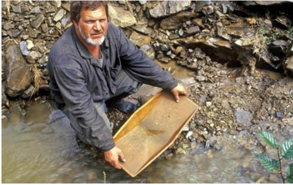
Рис. 4.7. Шлиховое опробование а - лоток для шлихования, б – точечная карта шлихового опробования
