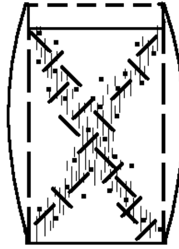
Возникновение зон скалывания и пластическое течение
