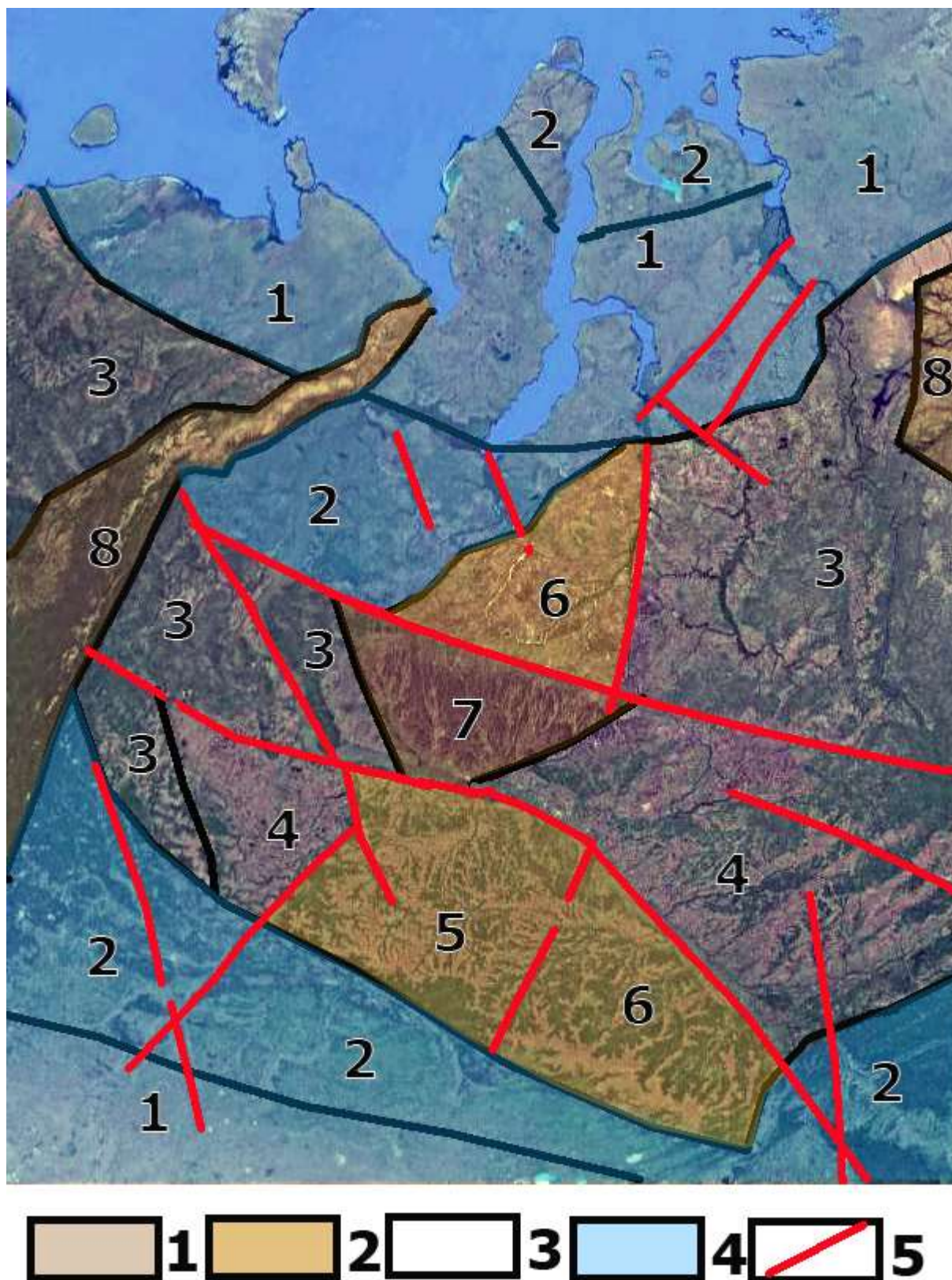
Рис. 4. Схема геологического дешифрирования космического изображения Западной Сибири. 1 – относительно интенсивные поднятия, 2 – относительно умеренные поднятия, 3 – относительно стабильные территории 4 – относительно прогибающиеся территории, 5 – линеаменты
