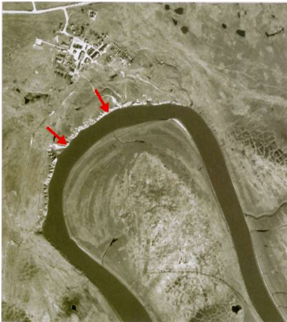
Рис. 4.20. Термоабразионные уступы (отмечены стрелками)
